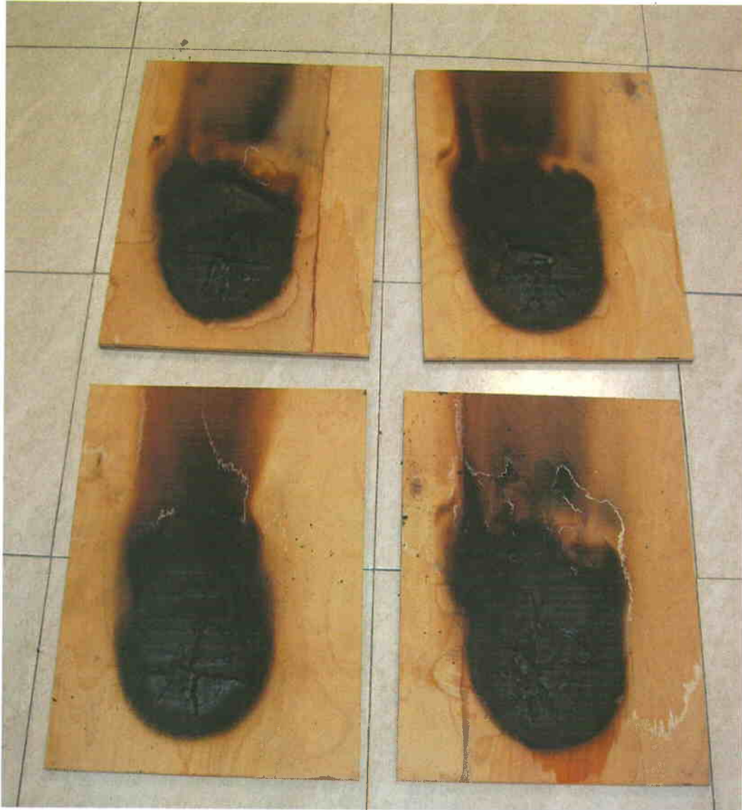
Aspecto de la muestra tras el ensayo de epirradiador según norma UNE 23721:1990
