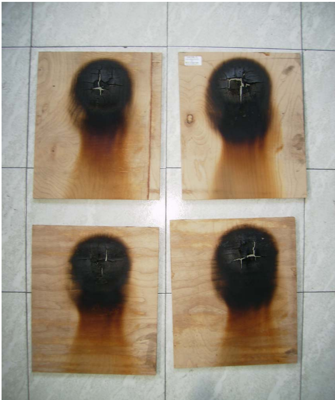
Aspecto de la muestra tras el ensayo de epirradiador según norma UNE 23721:1990
